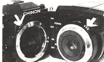
På AF-zoomens bagside ses de 3 koblingsstifter, der danner »navlestrengen« til kameraet. Desuden findes afbryder for strøm og »biip«.
